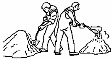
Commencer le mélange au sol en retournant le tas avec la pelle.
