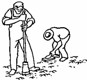
Désagrégation manuelle La terre sera bien étalée et désagrégée sur une surface dure de préférence.
