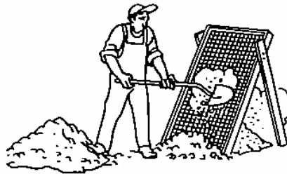
Tamis fixe manuel On jette la terre au sommet du tamis, incliné à environ 50°. En jouant sur son inclinaison, on peut augmenter ou diminuer les refus.
