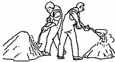
Retourner à nouveau le tas et continuer à verser la terre au sommet du tas, pour qu'elle coule.
