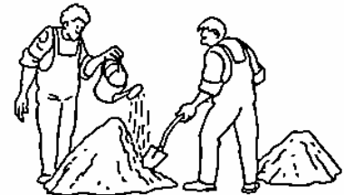
Retourner une deuxième fois le tas humide en continuant de l'arroser si nécessaire.
