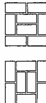
Fig. 61 d : Appareillage simplifié pour un pilier de 60 x 60 cm.
