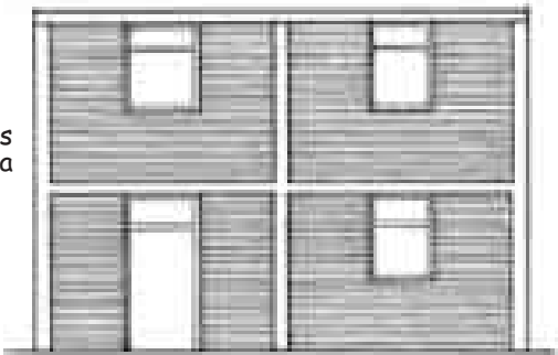
Vanos de ventanas y puertas bien ubicados
