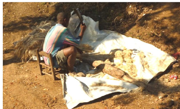
Préparation du pit pour le mortier.
